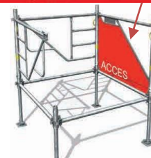
3 - Pose du cadre d'entrée qui facilite l'accès.
