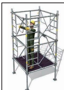
4 - Pose de 2 planchers à trappe et montage du 2 e niveau.
