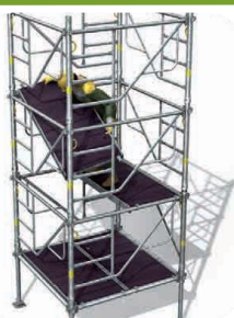
8 - Déplacement du 1 er plancher à trappe.
