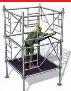
5 - Pose d'un 1 er plancher à trappe.
