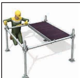
1 - implantation et mise à niveau. Vérification de l'équerrage en poussant un plancher dans l'angle.
