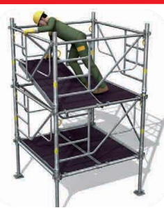
6 - accès au niveau supérieur puis pose du 2 e plancher à trappe.
